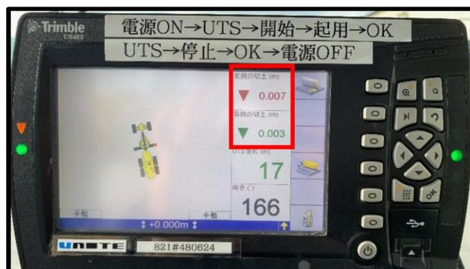
現時点の排土板の位置と、設計データとの高さの差分が表示され、感覚的な操作が可能
