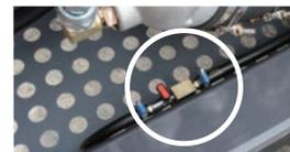
燃料タンクの水抜きコック
