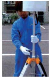
1.三脚を立てて投光機部分をロッドに差し込み、ロックハンドルで固定します。
